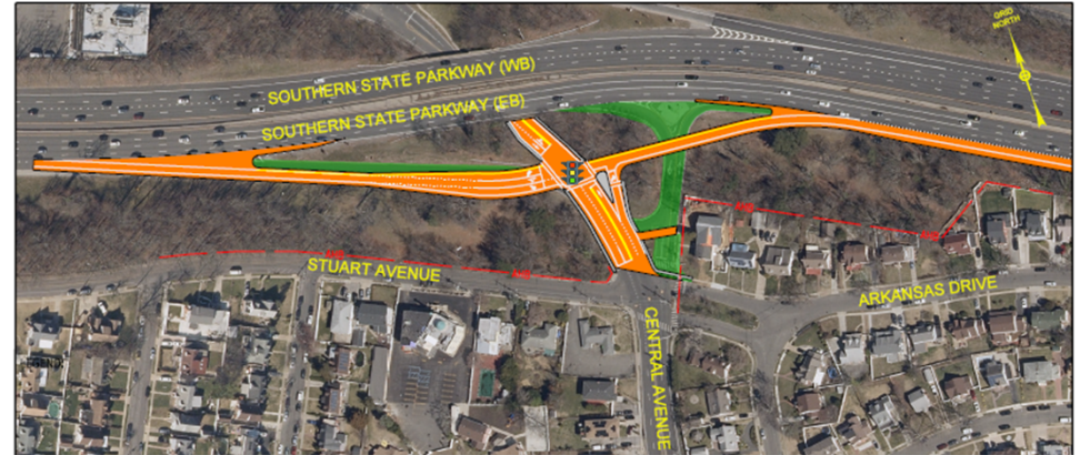
Alternativa de Diseño Preferida para la Reconstrucción del Intercambio de la Salida 13 en Dirección Este de Southern State Parkway
